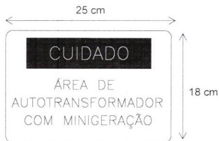
PLACA DE ADVERTÊNCIA
